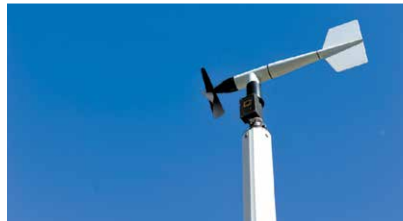
Le vent est mesuré grâce à un capteur pendant au moins une année.
